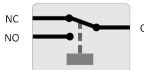
Relaiskonfiguration (nicht angezogen).
